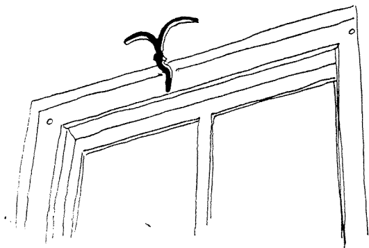
Afb. 55 Hogestraat 2, gevelanker (aangepast voor kozijn) laat-middeleeuws.
